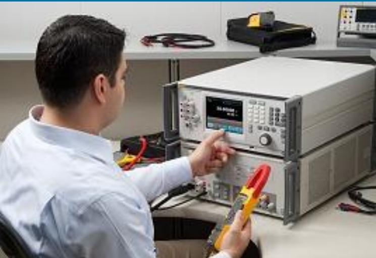
Калибровка электрических величин — проверка или настройка рабочих характеристик инструмента. Для калибровки используются высокоточные приборы, которые оценивают характеристики объектов испытаний (UUT)
