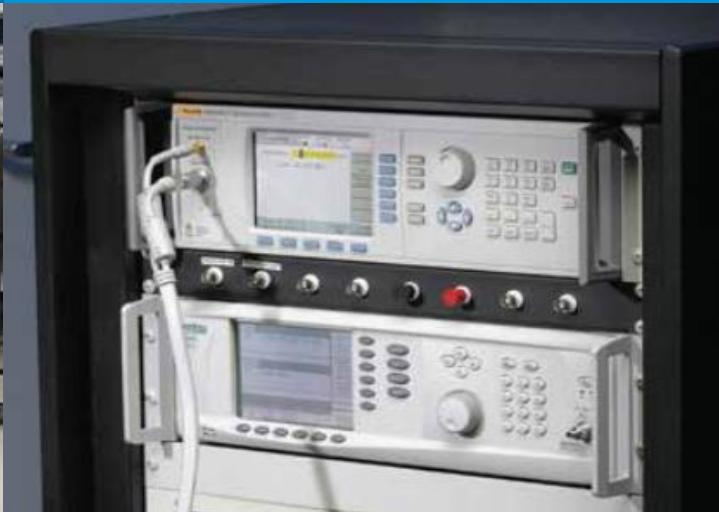
При поверке/калибровке ВЧ и микроволнового диапазона оборудования выполняется сравнение испытуемого объекта (DUT или UUT) с отслеживаемым стандартом калибровки или эталоном
